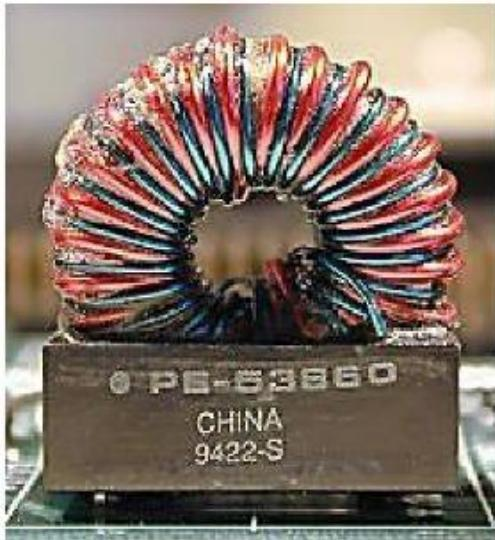
سلف ها می توانند در وسط سیم پیچ خود دارای یک هسته هوایی یا آهنی باشند. آهن مقدار اندوکتانس را افزایش می دهد. هسته بعضی از سیم پیچ ها مستقیم و برخی دیگر به صورت دوایر بسته مارپیچی است که راندمان بیشتری دارد، زیرا میدان مغناطیسی قوی تری در اطراف خود ایجاد می کند. سلف ها در تمامی مدارهای الکتریکی به خصوصی در ترکیب با رزیستورها و خازن ها به کار می روند و در کامپیوتر نیز به طور وسیعی به کار رفته اند.
